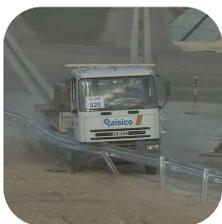
Ensayo: 4-12: Camión 8.000 kg - 80 km/h - 15°
