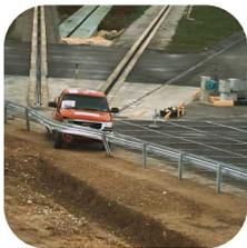
Ensayo: 4-11: Pick-up 2.000 kg - 100 km/h - 25°
